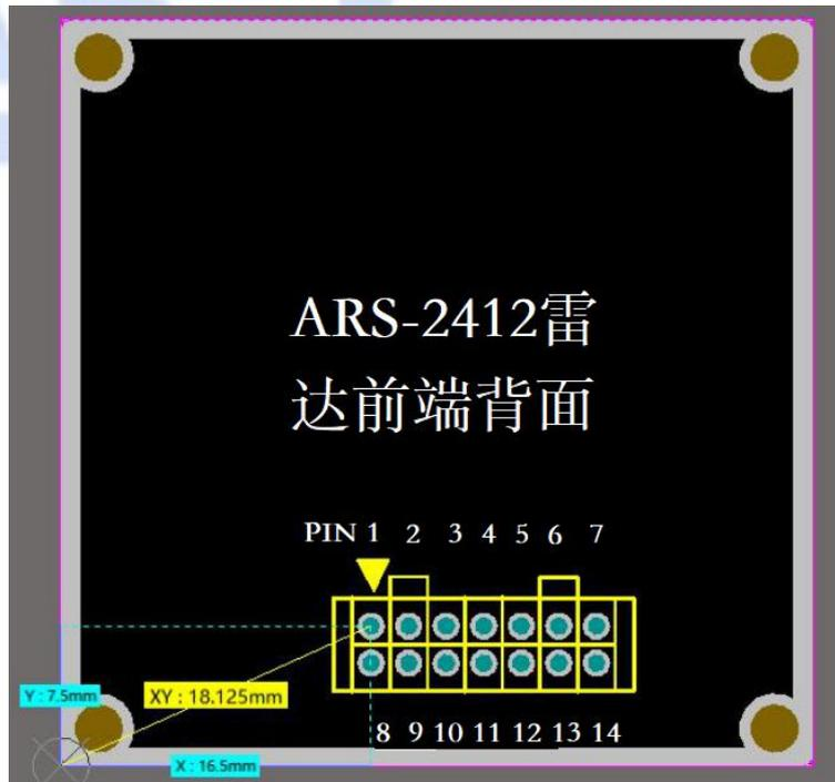
图 2 雷达前端外形参考图
